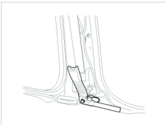
5. 拧下扣环拉紧器固定螺栓，拆卸扣环拉紧器。
